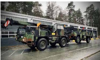
**Der Fahrzeugkran leicht beim Abschleppen eines LKW 5t gl.**
